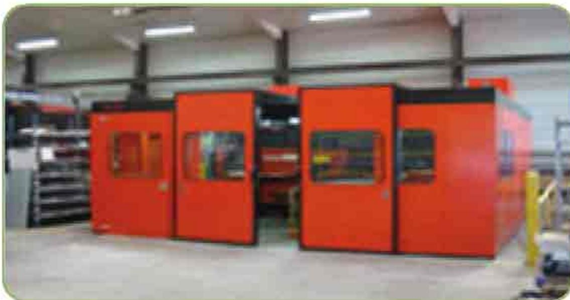
*Encoffrement d'une poinçonneuse (réalisation ISST).*
