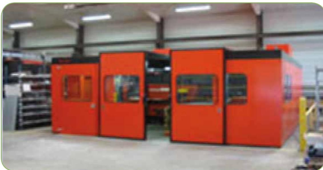
*Encoffrement d'une poinçonneuse (réalisation ISST).*
