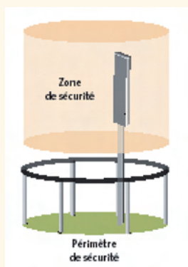
Figure 2 : délimitation de l'espace sécurité d'une station relais
