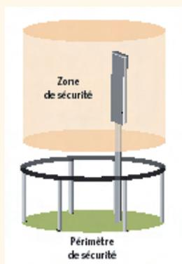
Figure 2 : délimitation de l'espace sécurité d'une station relais
