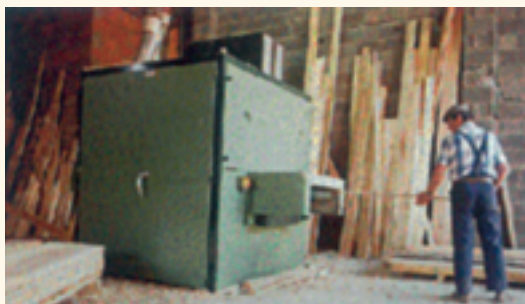
exemple de capotage d'une raboteuse : seuls le bouton d'arrêt d'urgence et l'accès pour l'alimentation sont accessibles
