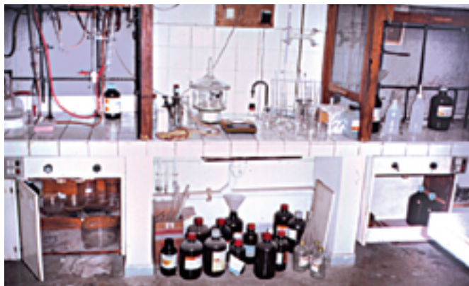
Paille emcombrée – implantation des sorbonnes non adaptée
