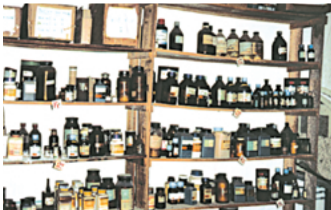
Incompatibilité de stockage- Risque de chute de récipients- étagères en bois déformées
