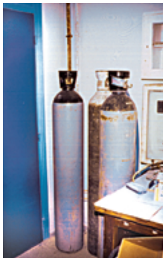
Bouteilles de gaz non attachées : risque de chute
