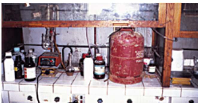
Sorbonnes utilisées comme lieu de stockage- encombrement- incompatibilité de produits
